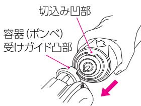
⑥ 右図のように容器(ボンベ)の頭近くに手を添えて、そのまま水平にスライドさせ、完全にマグネットに密着するまで押しつけて装着します。
