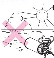
●夏の砂浜、砂利、アスファルトなど日光によって容器（ボンベ）が過熱するような場所でのご使用や放置はしないでください。容器（ボンベ）が過熱して爆発するおそれがあります。
