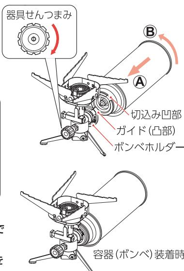
⑤ 容器(ボンベ)の切込み凹部をボンベホルダーのガイド(凸部)に合わせ、矢印Ⓐ方向に押しつけながら、矢印Ⓑ方向に止まるまで約45度回します。
