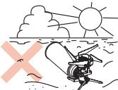
夏の砂浜やアスファルトなど日光によって容器(ボンベ)が過熱するような場所では使用しないでください。
