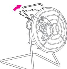
●正しく組み立てると、バーナーと容器(ボンベ)が地面に対してほぼ水平になります。
